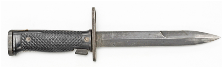
Symmetrische Klinge einseitig teilgeschliffen (z.B. Bajonett M6)
